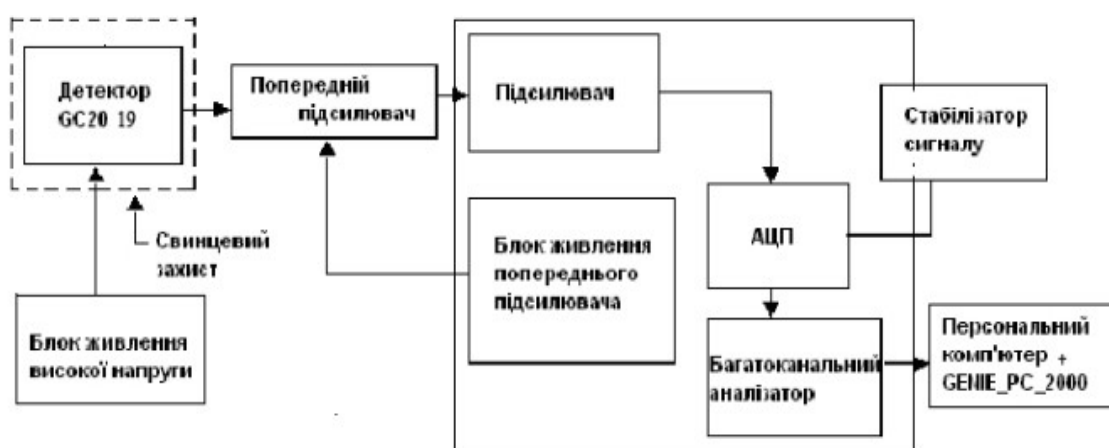
Рис. 1.2 Блок-схема спектрометричної установки.
