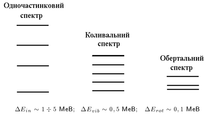
Рис. 3.9. Спектри збуджених станів в адіабатичній узагальненій моделі ядра
